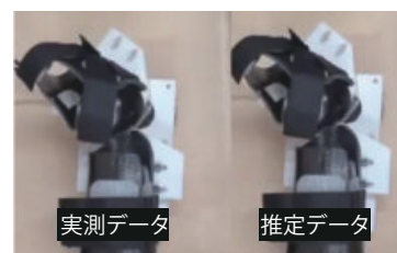
図2. 手首のロボットスーツを実測 (左) および推定 (右) した筋電信号で動かした例
