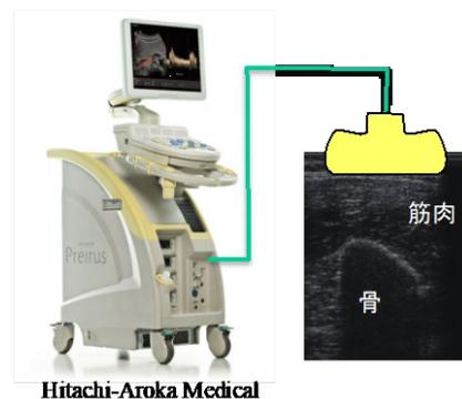
図2：超音波診断装置
