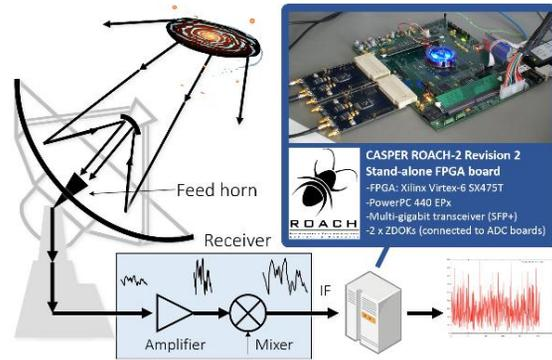
電波望遠鏡用信号処理装置の概要
